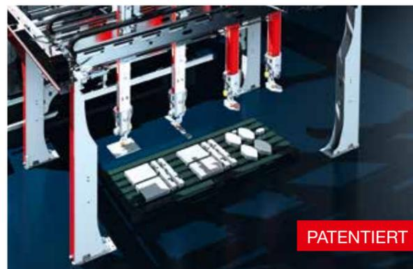
In Kombination mit dem Sortiermodul SortPro kann das Automationssystem sogar den Prozess der Einzelteil-Kommissionierung automatisch abbilden. SortPro besteht aus vier Teile-Kommissionierköpfen. Diese sind jeweils mit einem patentierten Revolverkopf ausgestattet, der auf sieben einzelne Vakuum- und Magnetwerkzeuge zugreifen kann. Maximale Automation bei maximaler Flexibilität.
