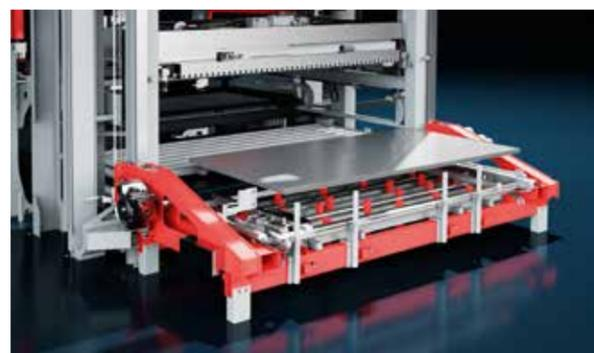
Zum Entpacken des Rohmaterials ist unterhalb des Regalbediengeräts eine Vorrichtung mit vielen Stempeln installiert. Dadurch können Holzbalken mit einer maximalen Höhe von 100 mm entfernt werden, ohne dass eine separate Auspackstation erforderlich ist.
