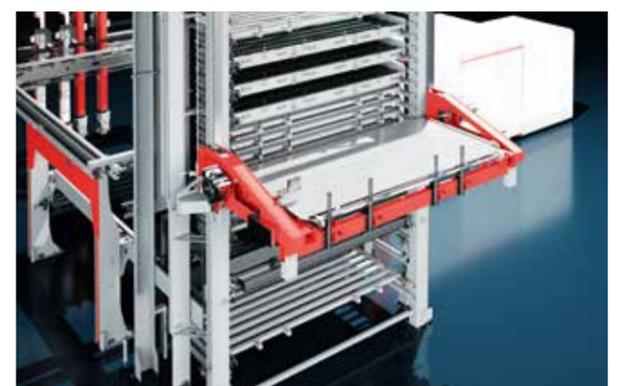
Das SkyWay kann an verschiedene Lagersysteme angebunden werden. Ob Einzelturm, Doppelturm oder Multi-Turm-Lagersystem – wir passen uns Ihren Anforderungen an. Um den Platzbedarf zu optimieren, kann das SkyWay direkt in ein automatisches Lagersystem integriert werden, indem beide Manipulatoren in den Lagerturm einfahren können.
