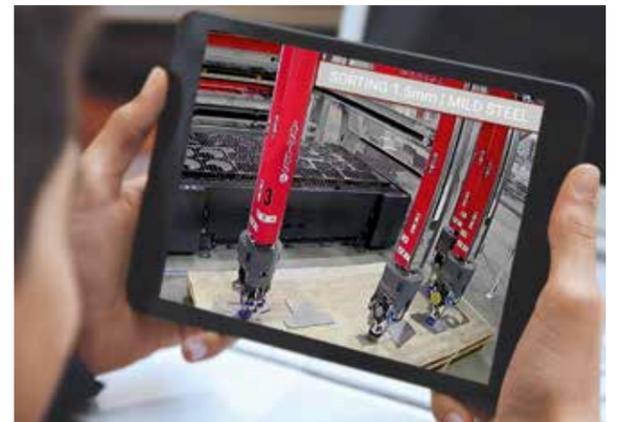
Die 4 Kameras, die an verschiedenen Stellen im System installiert sind, bieten einen detaillierten und direkten Überblick über den gesamten Automationsprozess, so dass unser Service-Helpdesk jeden Arbeitsschritt einzeln verfolgen und jederzeit per Fernsteuerung eingreifen kann.
