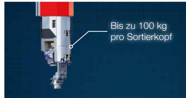
Jeder der 4 Sortierköpfe kann Teile mit einem Gewicht von bis zu 100 kg transportieren. Die Köpfe können einzeln oder zusammen verwendet werden, um große oder schwere Teile zu bewegen. Auf diese Weise können Teile mit einem Gesamtgewicht von bis zu 400 kg absortiert werden.
