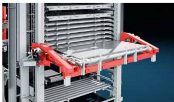
Das Regalbediengerät der StoreGo-Lagersysteme ist mit einer zusätzlichen Achse ausgestattet, um die Lagerpaletten/-kassetten schneller als konventionelle Systeme zu kommissionieren.
