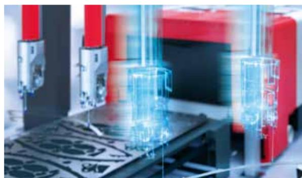
Wie wirtschaftlich kann ein Automationssystem sein, das nicht alle Teilegeometrien sortieren oder in der gleichen Ausrichtung abstackeln kann? Um alle geschnittenen Teile immer in der gewünschten Ausrichtung abzulegen, kann sich jeder Kopf um 360° drehen. Auch lange Teile müssen oft um 90° oder sogar 180° gedreht werden, um sie richtig oder wie gewünscht abzulegen. Die ASTES4-Sortiersysteme bewältigen diese Aufgabe mit Hilfe von zwei Sortierköpfen (einer von jedem Portal).
